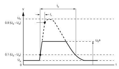
Fig. 8 - ISO-16750-2, Test Pulse B
