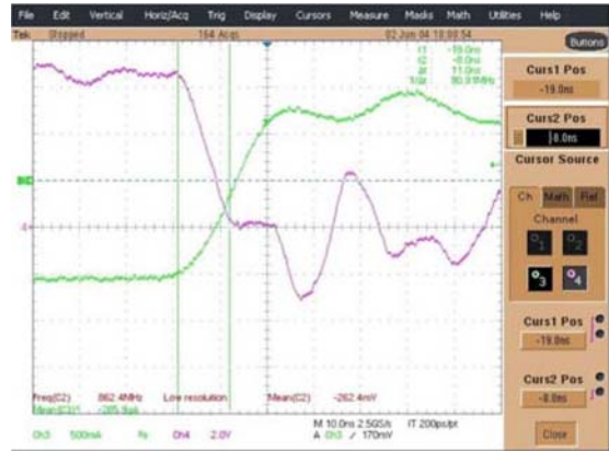
图 8 - 开启状态下开关瞬态值的测量电流值和电压值
