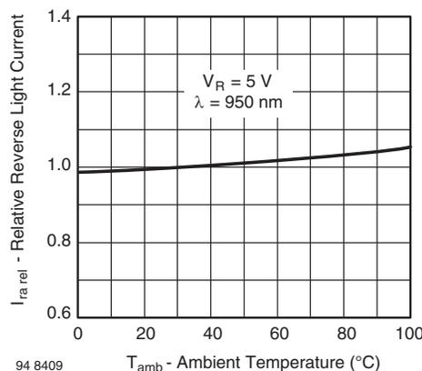
図 2 - 相対逆方向光電流 VS. 周囲温度
