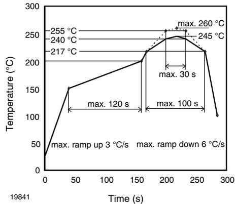
図 8 - 鉛フリーリフローはんだ付けプロファイル
